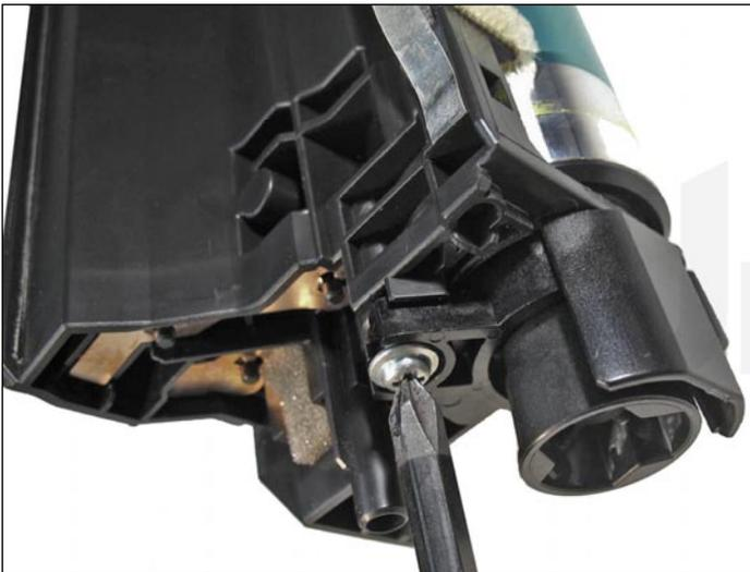
**DISASSEMBLING THE DRUM UNIT**
